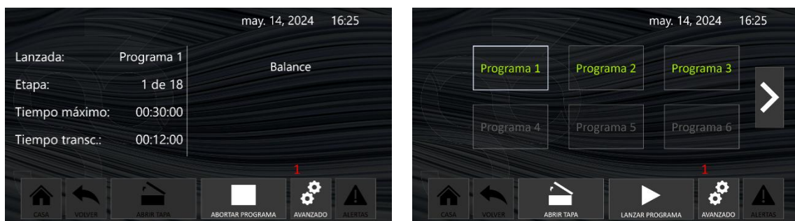
Fig. 50 Acceso a la pantalla de mantenimiento desde la pantalla del proceso (izquierda) o la pantalla principal (derecha)
