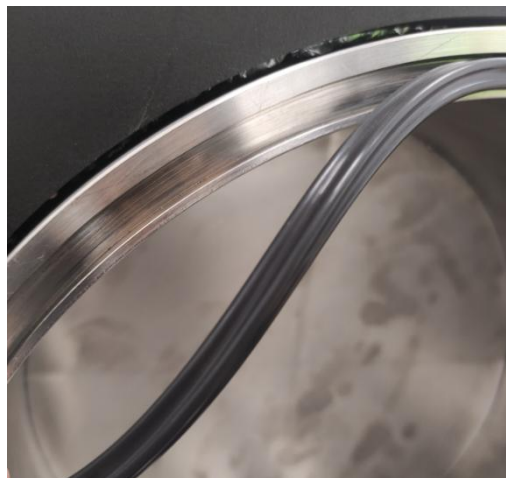
Fig. 12 Junta X-ring de la cámara de vacío
