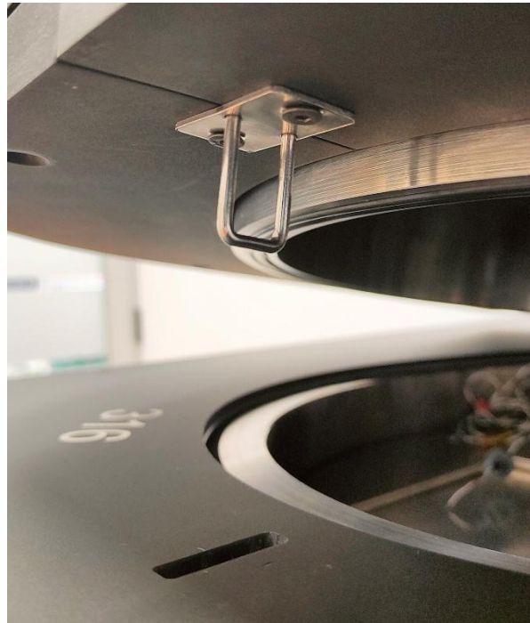
Fig. 13 Parte del enclavamiento de cierre de cámara de vacío
