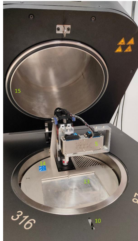
Fig. 4 Vista del interior de la cámara de vacío
