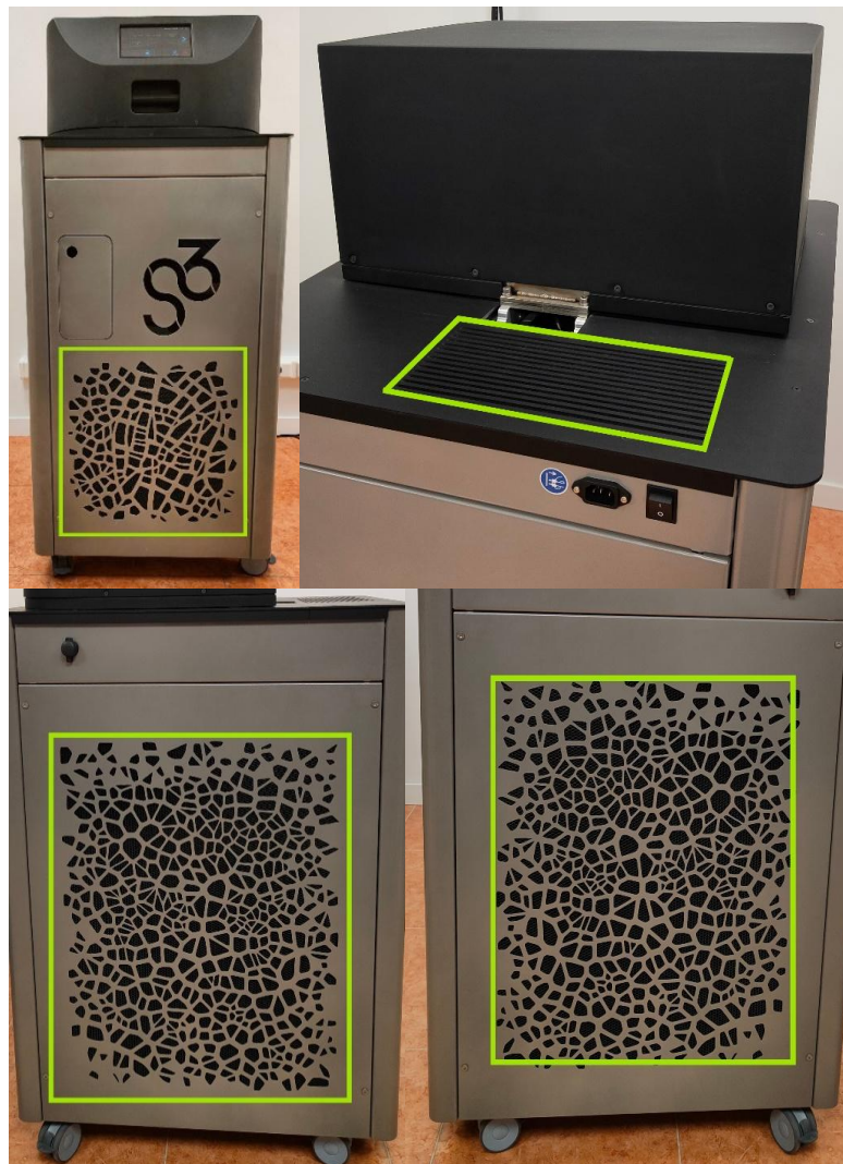
Fig. 24 Localización de las entradas y salidas de aire en el equipo S 3
