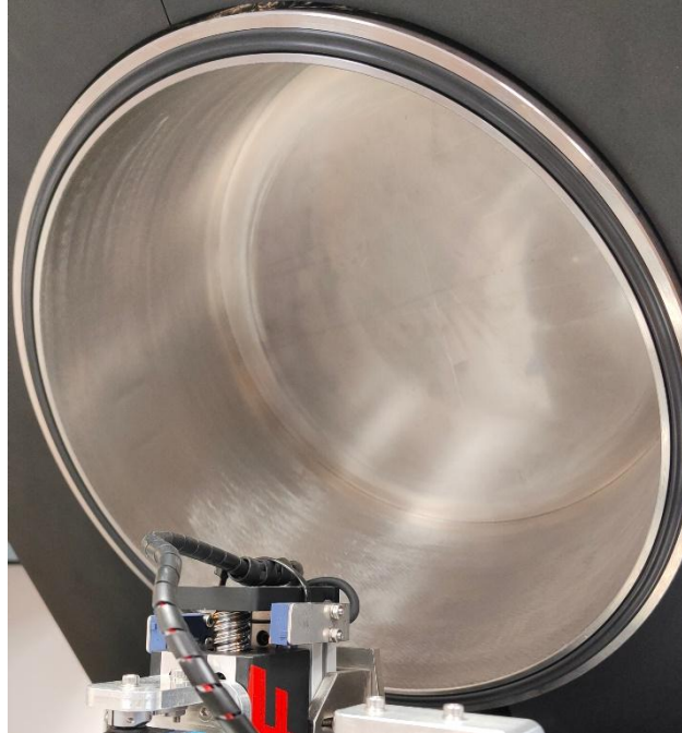
Fig. 11 Parte superior de la cámara de vacío
