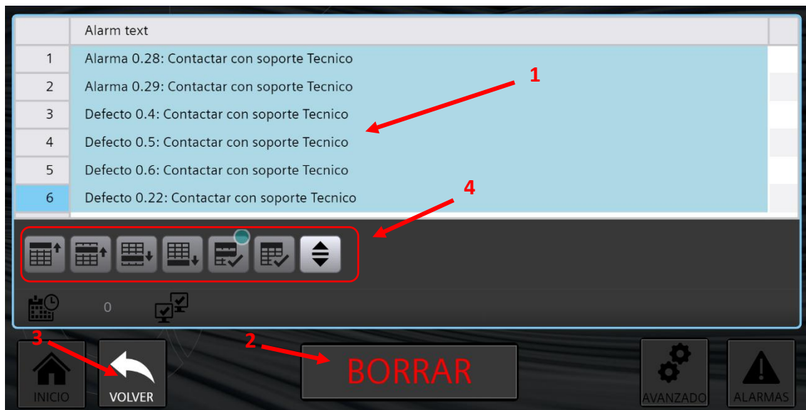
Fig. 43 Pantalla de alarmas y defectos
