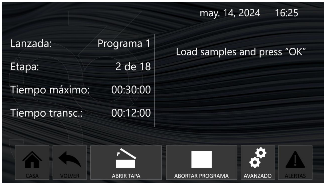
Fig. 40 El usuario debe abrir la tapa (botón coloreado de blanco) para cargar las muestras
